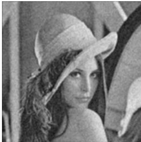
filtru mediere \text{SNR} = 21.5 \text{ dB}
