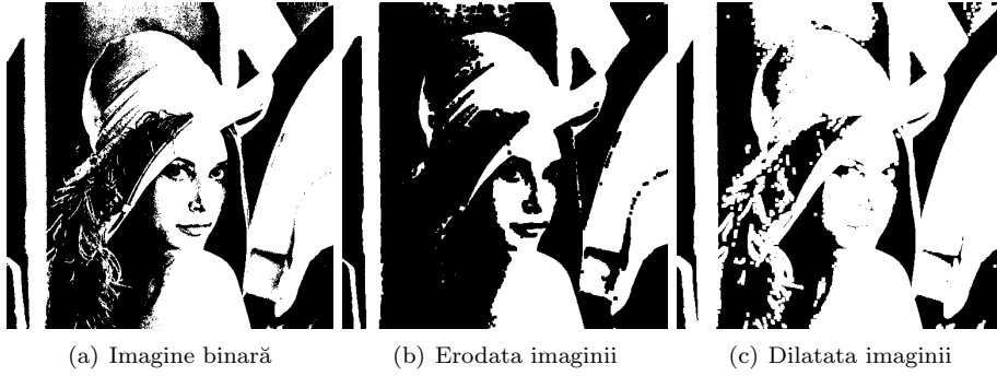
Figure 9: Erodarea și dilatarea unei imagini binare.
