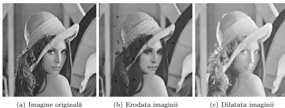
Figure 16: Erodata și dilatata unei imagini în tonuri de gri.
