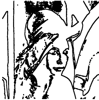
Figure 14: Gradient morfologic simetric pentru imaginea binară din Figura 9.
